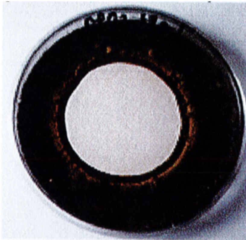
Assenza di sviluppo fungino su provino di "09021801 – Anticondensa"
