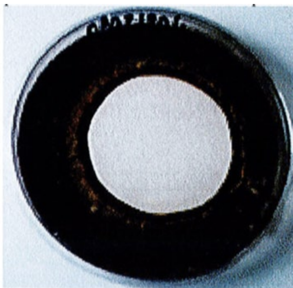
Assenza di sviluppo fungino su provino di "09021804 – Eko-San Antimuffa"
