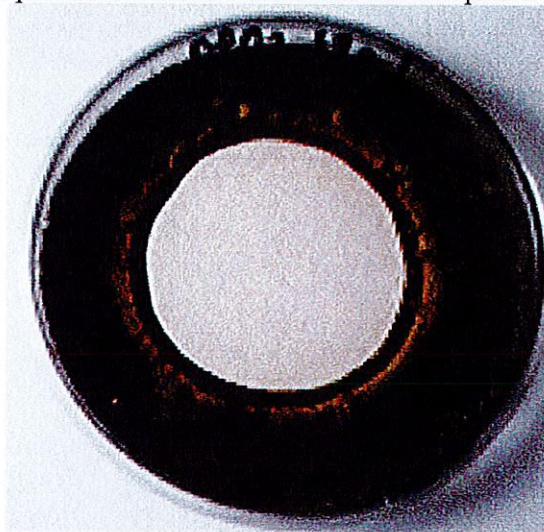
Assenza di sviluppo fungino su provino di "09021801 – Anticondensa"
