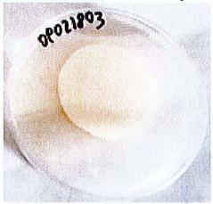
Controllo su substrato senza provino di pittura.
